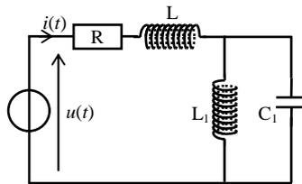
Une source de tension  $u(t) = U_m \cos(\omega t)$  alimente un circuit composé d'une bobine ( $R, L$ ) en série avec le groupement ( $L_1 // C_1$ ). La bobine ( $R, L$ ) est parcourue par le courant  $i(t) = I_m \cos(\omega t + \varphi')$ .
