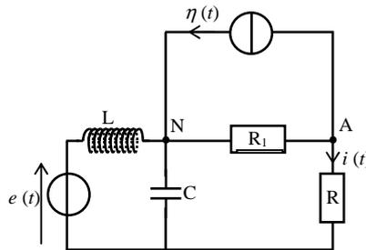
Considérons le circuit ci-dessus, comprenant une source de tension de f.e.m.  $e(t) = e_m \cos(\omega t)$ , et une source de courant de c.e.m  $\eta(t) = \eta_m \cos(\omega t)$ .
